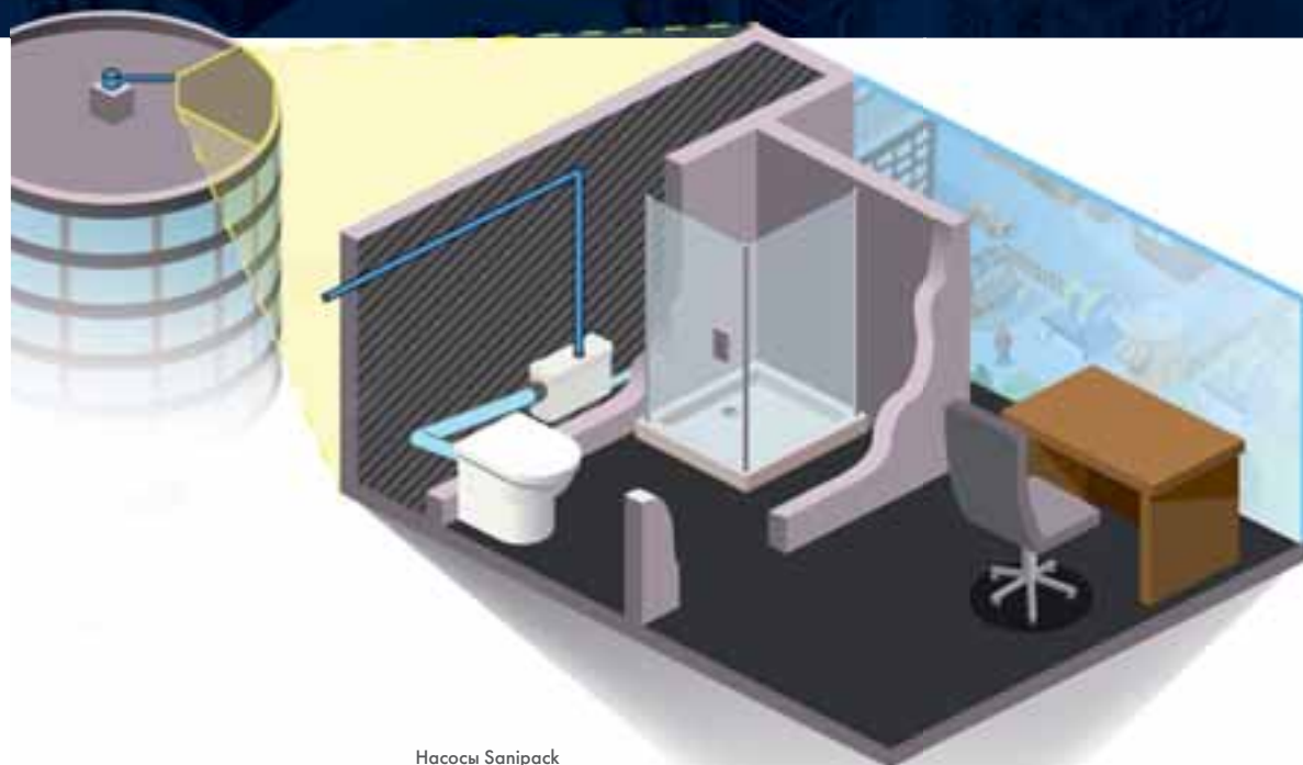
Насосы Sanipack перекачивают сточные воды в середину здания
